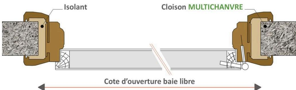
*Attention maintien des blocs au dessus de l'ouverture (étais, linteau + planche ou équerre + planche)*
