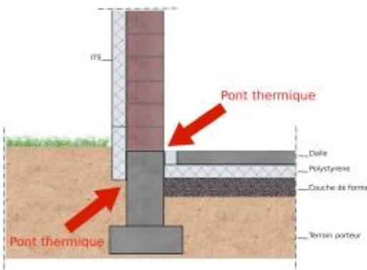
Fondation filante avec dalle sur vide sanitaire avec pont thermique
