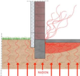
Le radon monte en pression sous le dallage, il se dépressurise au niveau du joint de dilatation ce qui génère une concentration élevée du radon dans l'habitation.
