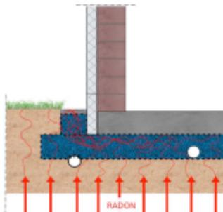
Grâce à MISAPOR, il est possible de supprimer la fondation par gel comme illustré sur la coupe de principe. Le granulat de verre cellulaire MISAPOR mis en place à un vide inter granulaire de +/- 30% ce qui laisse respirer la fondation et qui permet au radon de s'échapper sans qu'il monte en pression. En conclusion, grâce à l'isolation écologique et durable de MISAPOR, l'habitation est préservée d'une concentration de gaz de radon qui remonte par le sol.
